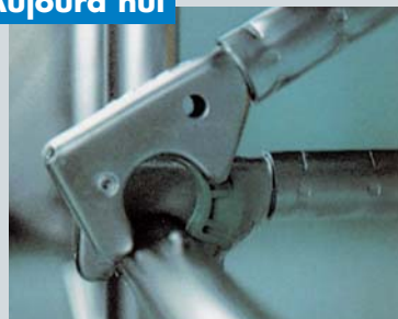
Blocage avec la mâchoire autoverrouillable LAYHER
