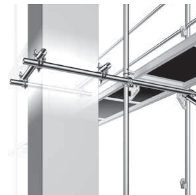
... ou sur poteau béton vertical.
