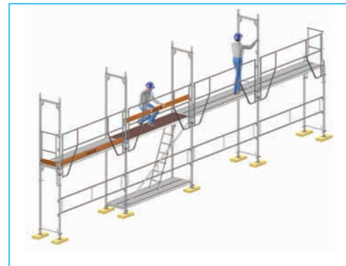
(4) Accès au 1 er étage et mise en place des montants et des plinthes du 1 er étage.
